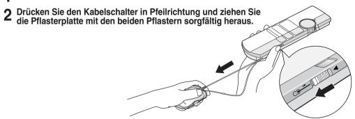
Hinweis: Bei einem geknickten oder verdrehten Kabel können beim Aufrollen Schwierigkeiten auftreten. Ziehen Sie in diesem Fall die Kabel zum Glätten und Reinigen sorgfältig mit einem Tuch ab.
