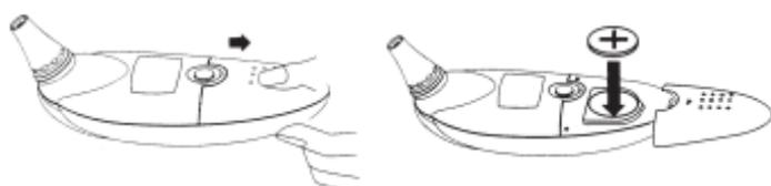
des Typs CR2032 ausgestattet. Ersetzen Sie die Batterie, sobald das Batteriesymbol auf der LCD-Anzeige erscheint.
