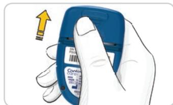
1. Schalten Sie das Messgerät vor dem Batteriewechsel aus.
