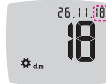
6. Um das Jahr (blinkt) zu ändern, drücken Sie die Taste ▲ bzw. ▼ und anschließend die **OK**-Taste.
