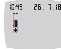
Das Messgerät schaltet sich ein und zeigt einen Sensor mit einem blinkenden Blutstropfen an.
