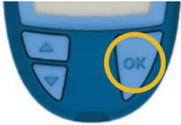
1. Drücken und halten Sie die **OK**-Taste, bis sich das Messgerät einschaltet.
