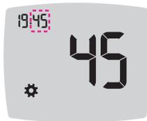
7. Um die Minuten zu ändern, drücken Sie die Taste ▲ bzw. ▼ und anschließend die **OK**-Taste.
