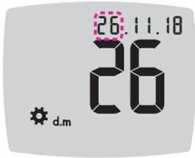
8. Um den Tag (blinkt) zu ändern, drücken Sie die Taste ▲ bzw. ▼ und anschließend die **OK**-Taste.
