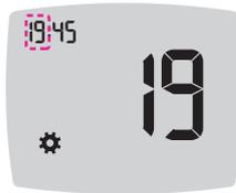
6. Um die Stunde zu ändern, drücken Sie die Taste ▲ bzw. ▼ und anschließend die **OK**-Taste.
