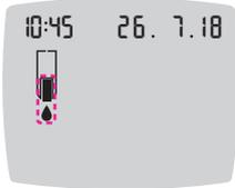
Auf der Anzeige erscheint ein blinkender Blutstropfen. Dies bedeutet, dass das Messgerät bereit für die Messung ist.
