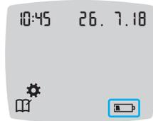
Ihr Messgerät funktioniert weiterhin normal, zeigt aber das Symbol **Batterien schwach** an, bis Sie die Batterien austauschen.
